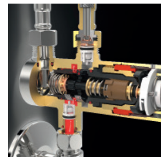
Wirksamer Schutz vor Verbrühungen: Bei Kaltwasserausfall wird der Warmwasserzugang sofort geschlossen.
