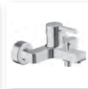
HANSAFORM Einhand-Wannen-Batterie, DN 15 (G 1/2) 4974 2103 verchromt Ausladung: 159 mm
