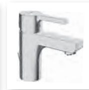
HANSAFORM Waschtisch-Einhand-Einlochbatterie, DN 15 für offene Heißwasserbereiter 4913 1103 verchromt Ablaufgarnitur (Metall), Anschluss über Kupferrohre Ausladung: 99 mm
