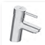
HANSAVANTIS STYLE Waschtisch-Einhand- Einlochbatterie, DN 15 5242 2277 verchromt ohne Ablaufgarnitur, Anschluss über flexible Druckschläuche G 3/8 Ausladung: 102 mm HANSAVANTIS 5242 2273 verchromt
