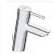
HANSAVANTIS STYLE XL Waschtisch-Einhand- Einlochbatterie, DN 15 5256 2277 verchromt Ablaufgarnitur (Metall), Anschluss über flexible Druckschläuche G 3/8 Ausladung: 104 mm HANSAVANTIS STYLE XL 5238 1177 verchromt # für offene Heißwasserbereiter
